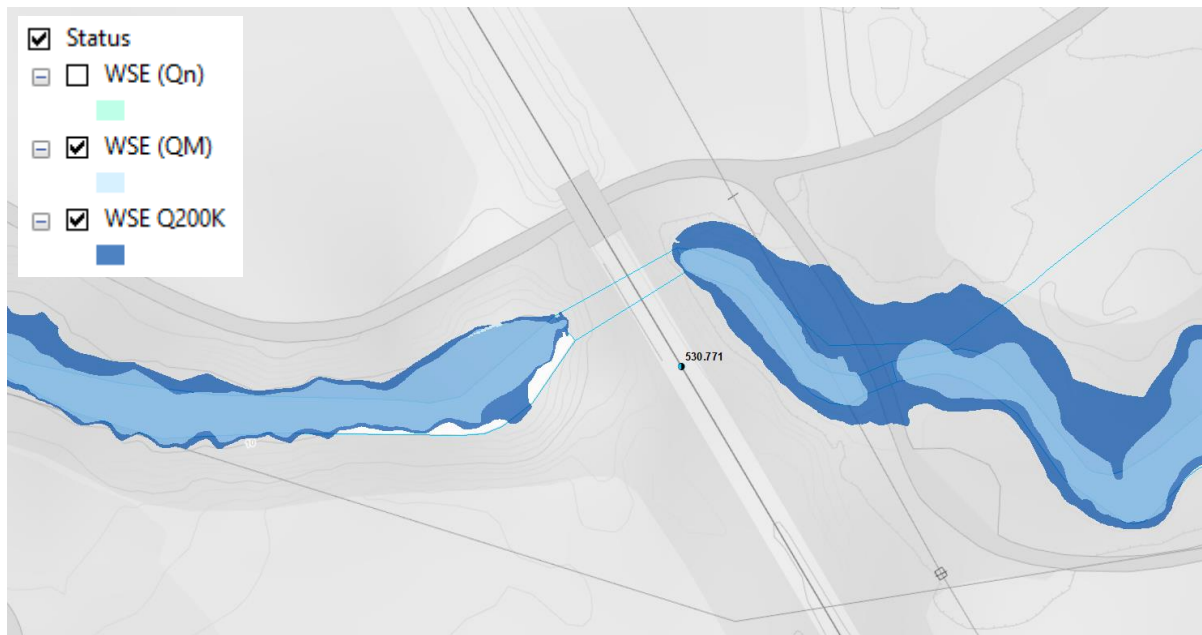
Figur 4-16 Flomsonekart for eksisterende situasjon og Q200+klime vist i mørkt blått. Lys blått viser flomsone for årsflom (QM).
